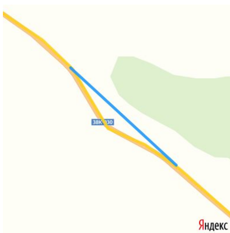
Рисунок 18 – Схема реконструкции (спрямления) участка дороги Рыльск – Коренево – Суджа, 32 км
